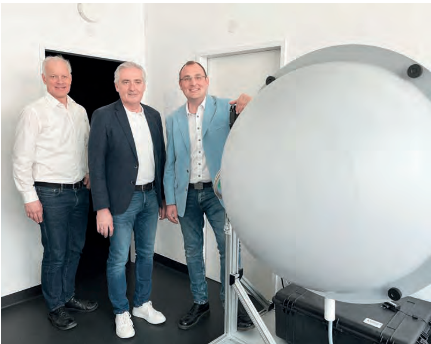
Paul Hartmann, Manfred Gerger und Andreas Weiss mit der Ulbricht-Kugel im Labor. Damit können die Stärke und die Farbverteilung von Licht gemessen werden.
